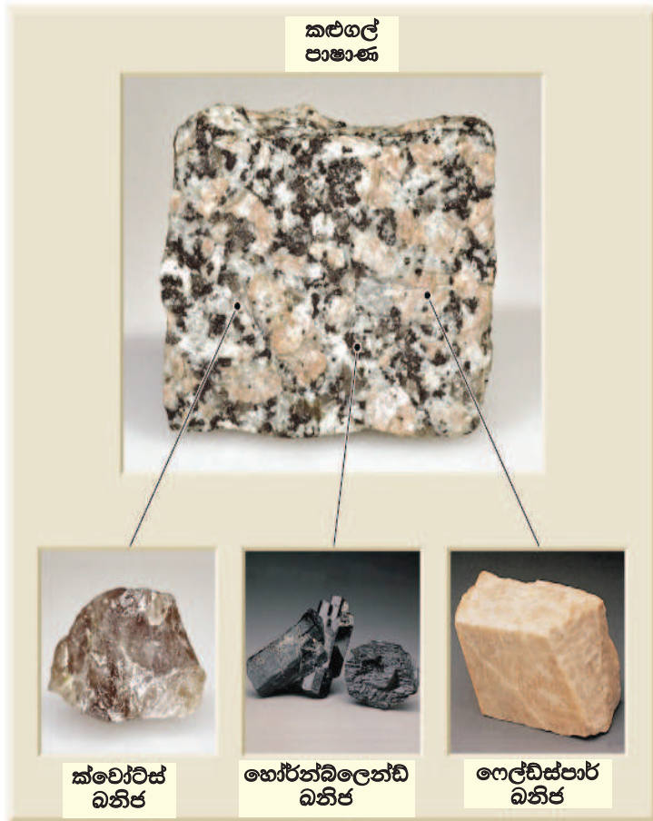
වන රූපය: පාෂාණයක් සෑදීම සඳහා විවිධ බහිෂ් වර්ග එකට ඇතිව තිබෙන්නේ කෙසේද යන්න විස්තරය මගින් විග්‍රහණය කෙරේ
