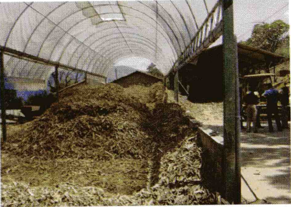
2 වන ඡායාරූපය : දුර (ග්ලිරසිසියා) භාවිතා කරන මෙගාවොට් 1ක ඩෙන්ඩ්‍රො බලාගාරයක ගබඩා කිරීමේ වපසරිය (අනුග්‍රහය : ලංකා ට්‍රාන්ස්ෆෝමර්ස් ලිමිටඩ්)
