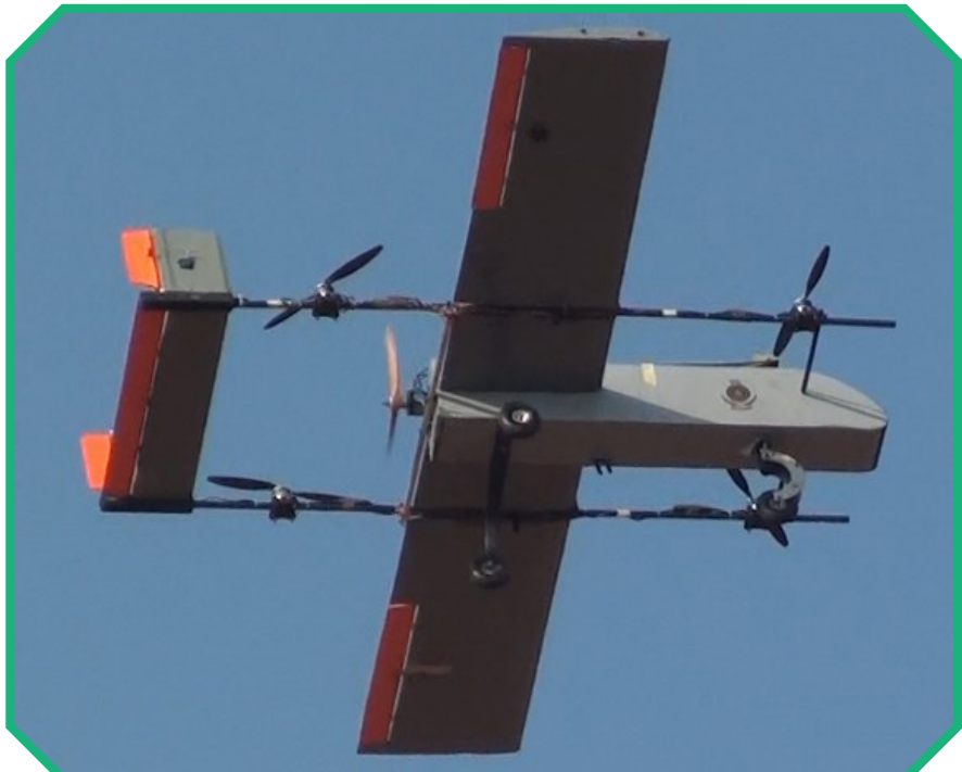
5 වන රූපය: හොර්නට්, මොරටුව විශ්වවිද්‍යාලයේ සිවුහුමණ පත් දෙමුහුම් ඩ්‍රෝනය (ජාතික පර්යේෂණ මණ්ඩලයේ ලෝක බැංකු 'අහෙඩ්' ව්‍යාපෘතියේ අරමුදලිනි
