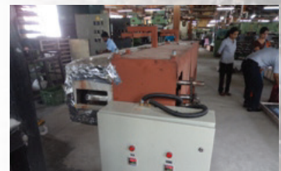
ප්‍රදානලාභියාගේ කර්මාන්ත පරිශ්‍රය තුළ සංවර්ධනය කරන ලද අඛණ්ඩ කාණ්ඩ වාත්තු කිරීමේ යන්ත්‍රය
